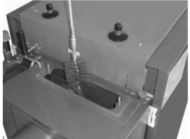
Vorführung der Reinigung des Rauchkanals mit Drahtbürste.
