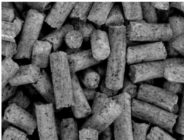
Holzpellets schlechter Qualität – Dunkelpellets mit Rinde (mit schwarzen Punkten)
