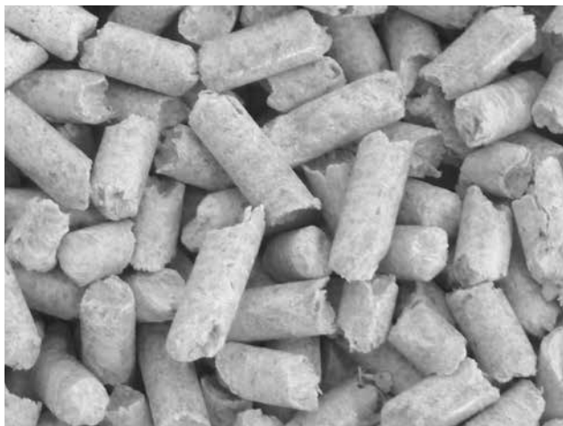
Hochwertige Holzpellets – Weißpellets ohne Schwarzpunkte (Rinde)
