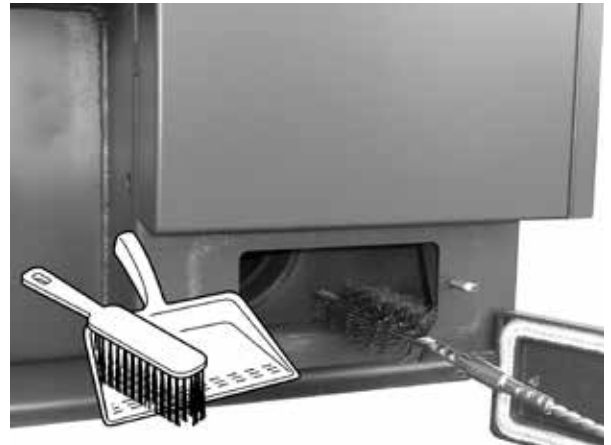
Muster – die Reinigung des Rauchkanals – unterer Deckel
